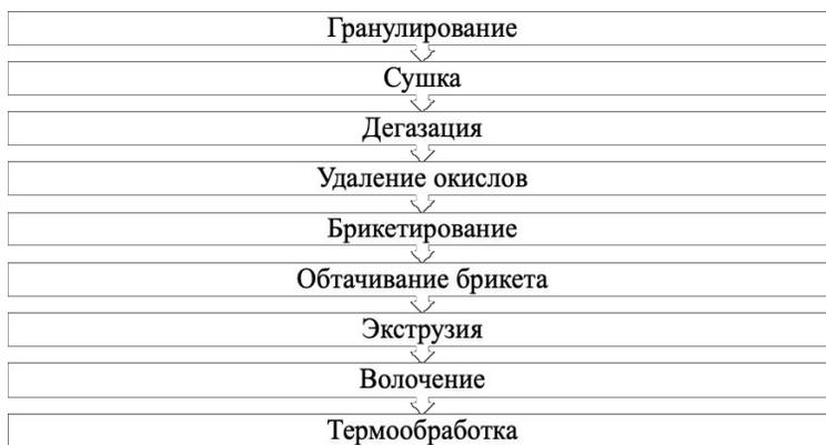
Рис. 1. Технологическая схема получения проволоки из гранул
